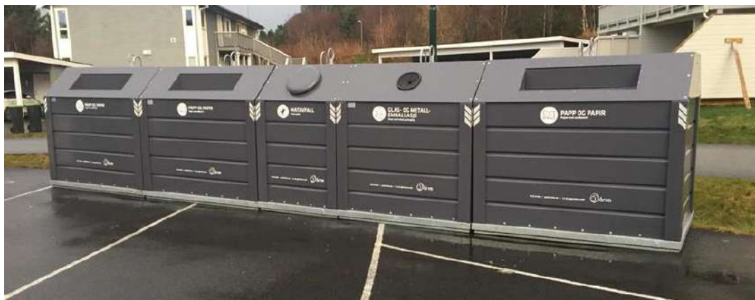
Figur 5. Bakkekonteinar med dobbel løftekrók. Konteinaren brukast i burettslag og andre tettbygde områder. Leverast i storleik mellom 2,2-4,2m 3 . Tømmast med kranbil.
