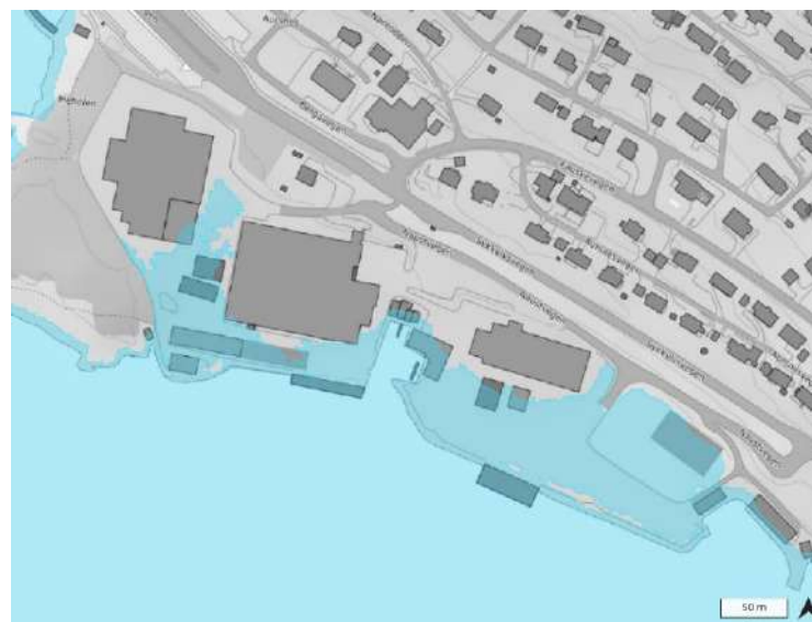
Figur 37: Kartet viser stormflo for dagens situasjon. Basert på 200-års-hendelse. Kart fra Se havnivå i kart | Kartverket.no .
