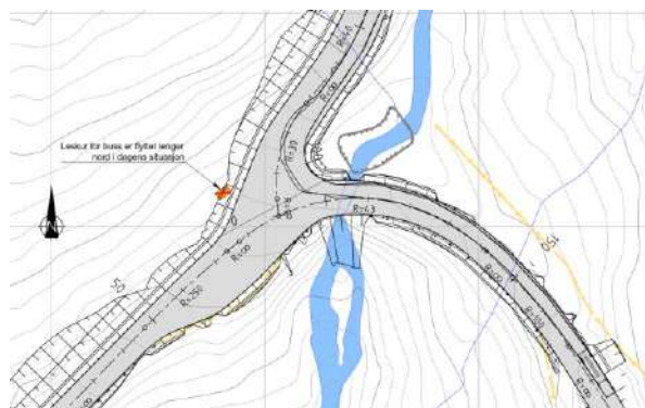
Figur 12 - Sporing L fra øst mot nord
